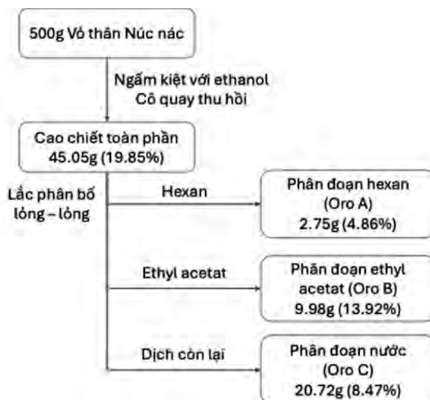
Hình 1. Sơ đồ chiết xuất vỏ thân Núc nác
